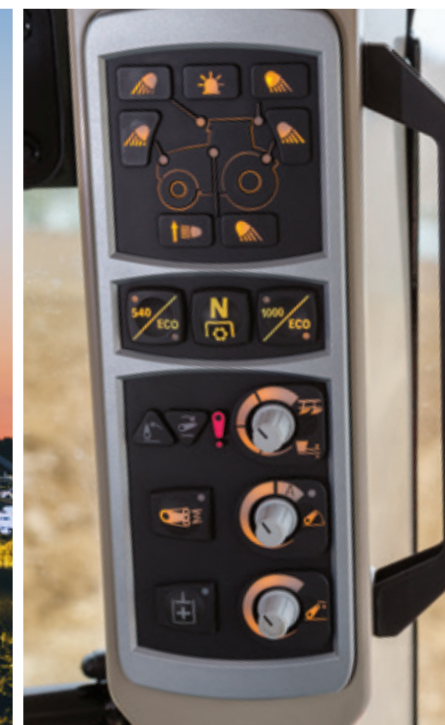
CONTROLES INTUITIVOS. En el pilar del lado derecho, la disposición de los controles, fiel al estilo familiar de Massey Ferguson, incorpora módulos para el control de las luces, la selección de la velocidad de la TDF y los ajustes del elevador trasero.
