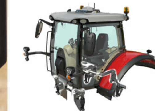
LA CABINA SUSPENDIDA EN CUATRO PUNTOS aporta una mayor comodidad.
